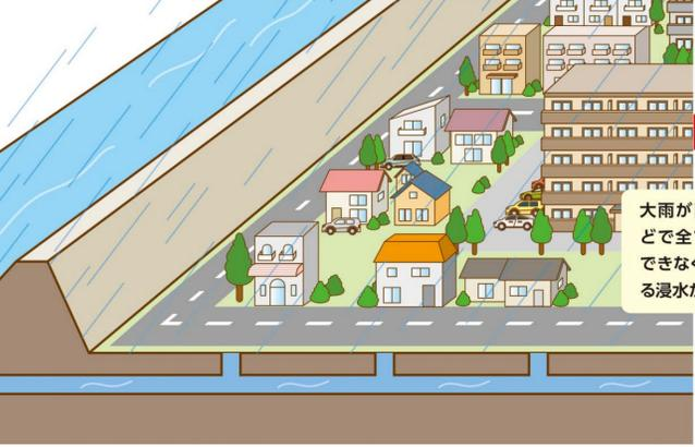
宅地に降った雨は雨水ますへ、道路に降った雨は道路側溝などに集まり、下水道や水路等を通して河川に排水されます。
