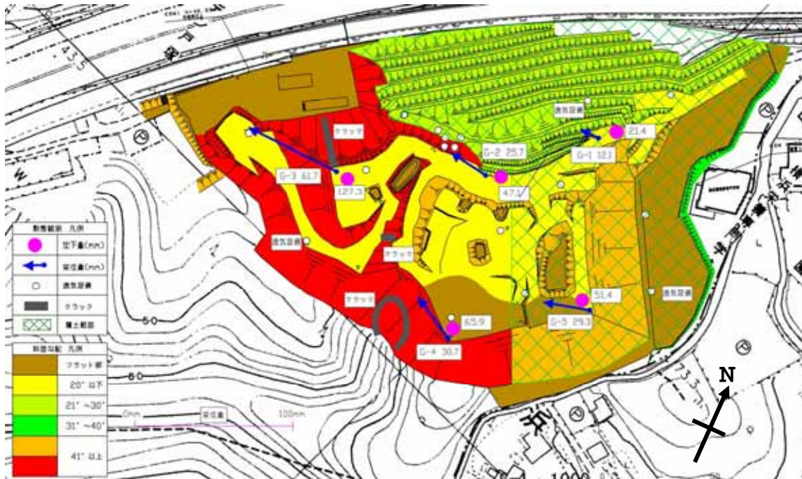
図 - 2 . 14 積上げ廃棄物における法面の整形状況及び変位状況等
