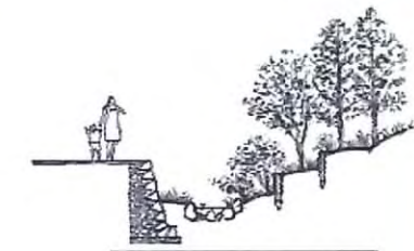
多自然型護岸と水路
