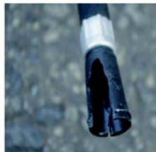
× ノズルの破損
