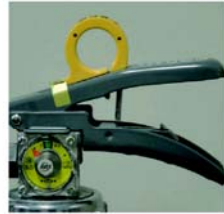
× レバー支えの脱落
