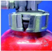
× キャップの破損
