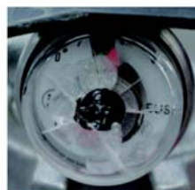
× 指示圧力計の損傷
