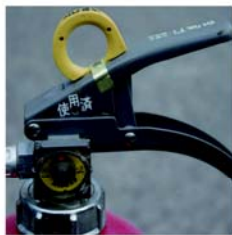
× 表示装置の脱落
