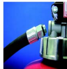
× 緊結ネジの破損 × ホースの脱落
