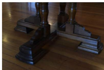
テーブルの側面は木工旋盤<sup>※4</sup>で加工。脚部は1本脚ではなく、木工旋盤<sup>※4</sup>で加工された4本が集合体として使われた重厚感のあるデザイン。
