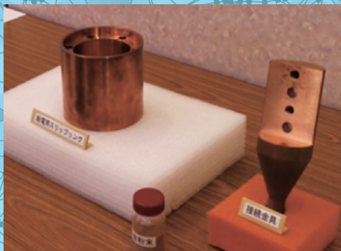
銅系の材料による造形例 大阪府立産業技術総合研究所
