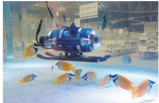
小型水中テレビロボット DELTA-100R
