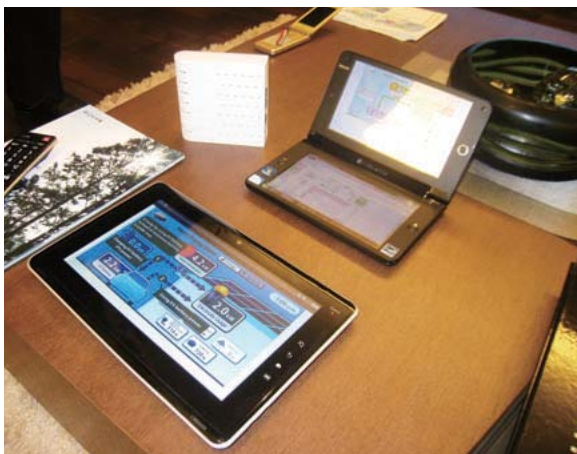
家庭内のエネルギー消費量と再生可能エネルギーの利用量が見え、家電及び CO 2 を一括管理することができるタブレット型パソコン
