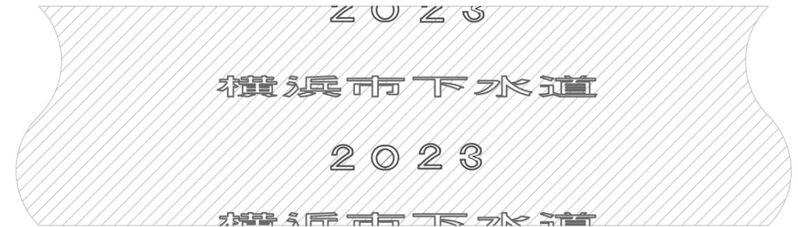
管頂に表示テープを3本タテ方向に貼り付け1.5m以内のピッチでハチ巻き状に2回巻きする。
