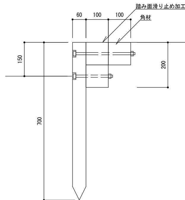
・擬木は再生プラスチック木粉混入材とし、木粉混合率は5～15%（重量比）とする。
