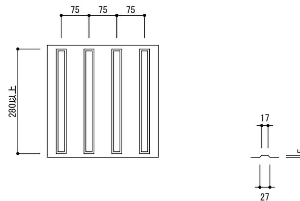
・ブロックの突起の形状寸法およびその配列はJIS規格による。
