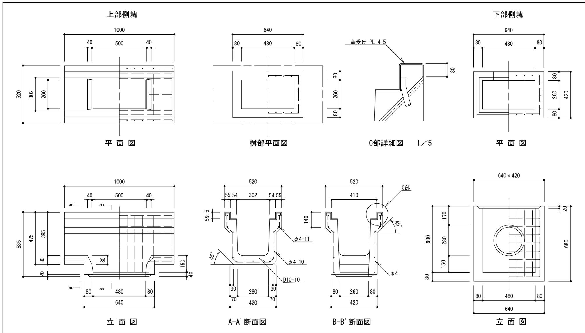
・蓋受けは、一般構造用圧延鋼材（SS400）電気亜鉛めっきとする。
