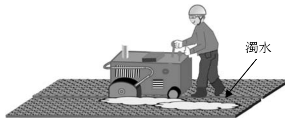
図表2-2-9 舗装切断作業のイメージ
