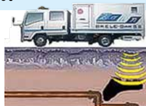
路面下空洞調査のイメージ▶
