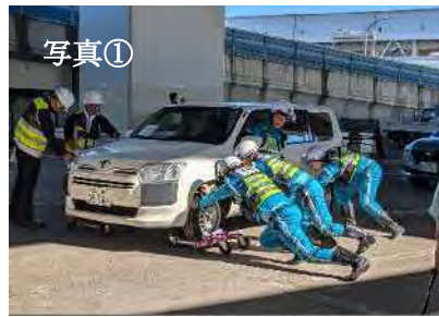
写真① 専用資機材を用いた車両移動
