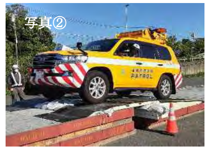
写真② 軽量素材により解消した段差の乗り越え
