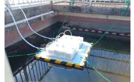
最終沈殿池での N<sub>2</sub>O ガス捕集の様子
