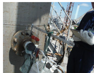
排ガス測定の様子 (煙道からの試料採取)
