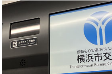
<4000 形車両に設置した防犯カメラ>
