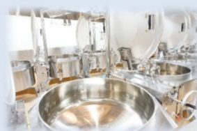
工場に設置された大型の回転釜
