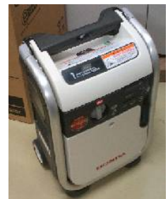
【ガス式発電機】
