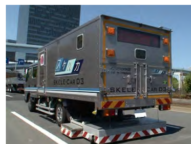
空洞探査車による調査
