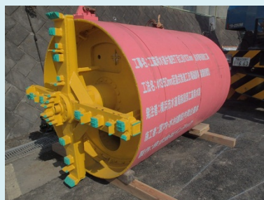
地下にトンネルを掘る機械 （推進機 外径 1600mm）
