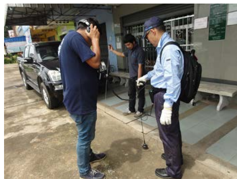
現地での漏水調査 (タイ)
