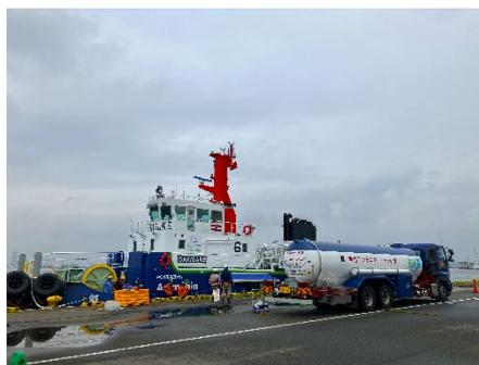
図48 アンモニア燃料タグボート/Truck to Shipによるバンカリングの様子
