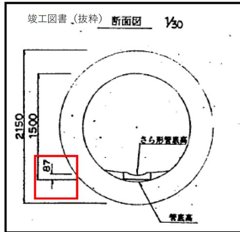
測量成果は皿形管底高で行われたと想定し、87mmを考慮して設定するため、管底高を補正します。
