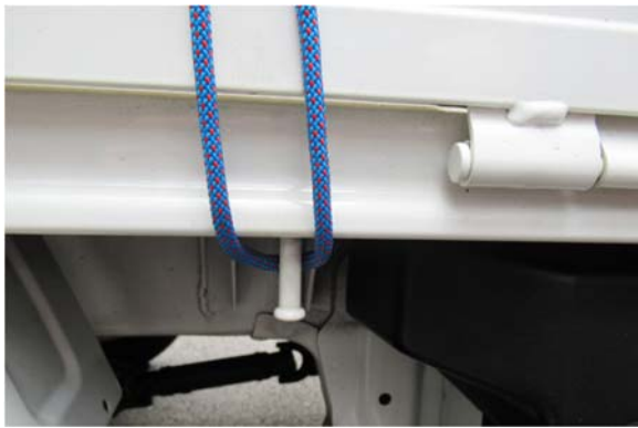
⑦ 引き出したロープをフックやカラビナなどに掛ける
