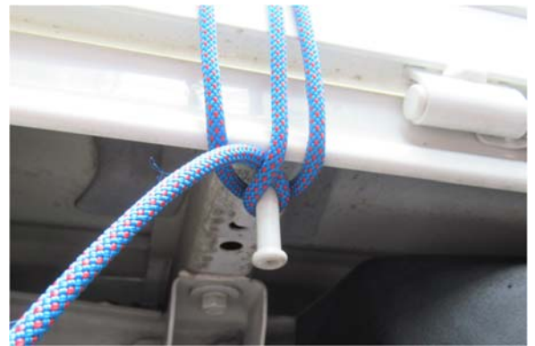
⑨ 写真のように結び目を止めて、南京結び完成！
