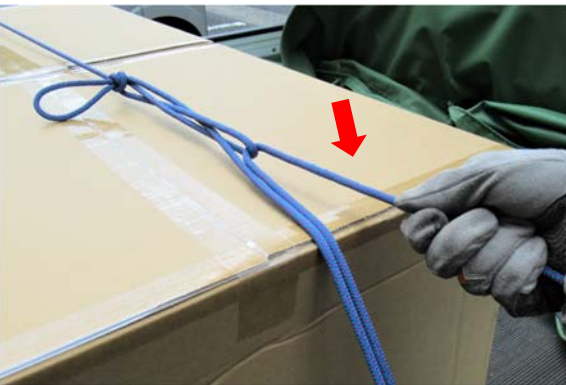
⑧ 写真で持っている部分のロープを引くことで約3倍の力でロープを張ることができる
