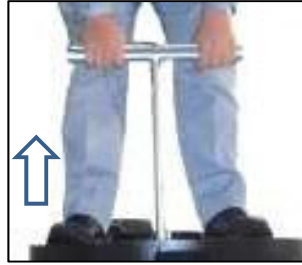
貯留弁引き上げ状況
