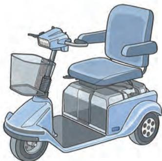
前輪に連動したハンドルとアクセルレバーで操作するハンドル形電動車いすです。手動の車いす操作の耐久性がない人が効率的かつ安全に移動するために利用しています。
