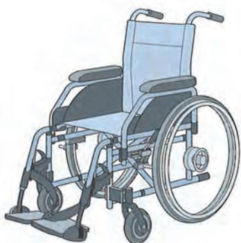
折りたたみ式で大車輪が後方にあります。後輪に自走用のハンドリムがついています。JIS T9201-2016に規定されています。
