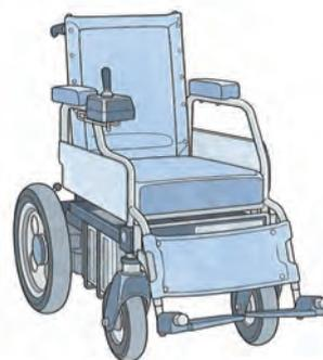
フレームにバッテリーと電動モーターを搭載した車いすで、ジョイスティックレバーで操作する標準形電動車いすです。自走用に比べると重量も重く回転半径も大きいです。
