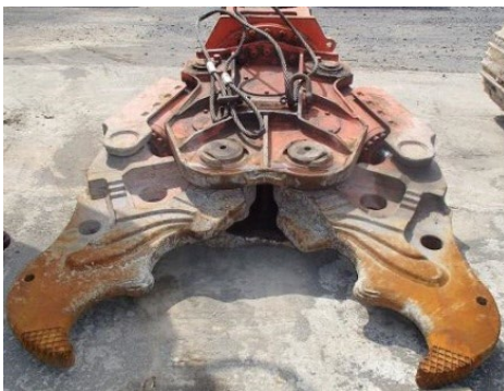
低騒音・低振動工法の例 解体重機アタッチメント
