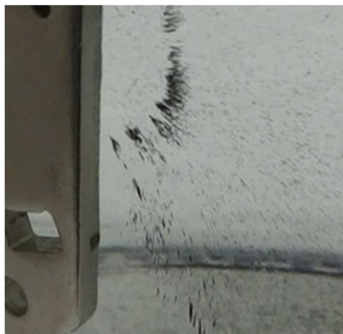
写真4 磁石に吸い付けられる異物
