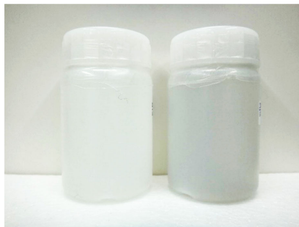
写真2 受水槽水(左)と灰色に着色した4階給水栓水(右)
