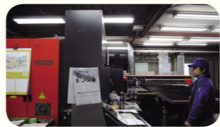
ターレットパンチプレス機で鉄板に孔をあける様子
