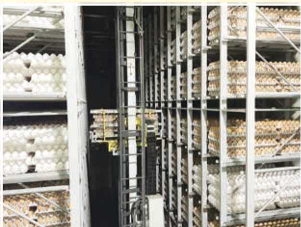
本社GPセンターでは洗卵・選別工程とパッキング工程の間に自動倉庫を導入。万全な管理の下、多品種大量生産が可能に。工場見学に訪れる子どもたちからは驚きの声
