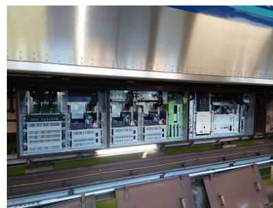
▲ATC 装置・・・列車速度を自動的に制御する装置
