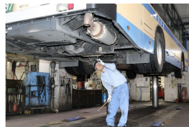
バス車両整備工場の整備用リフト
