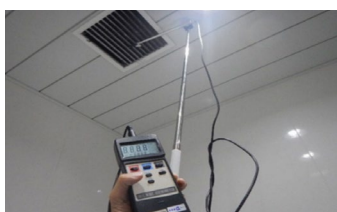
風速計による換気能力測定
