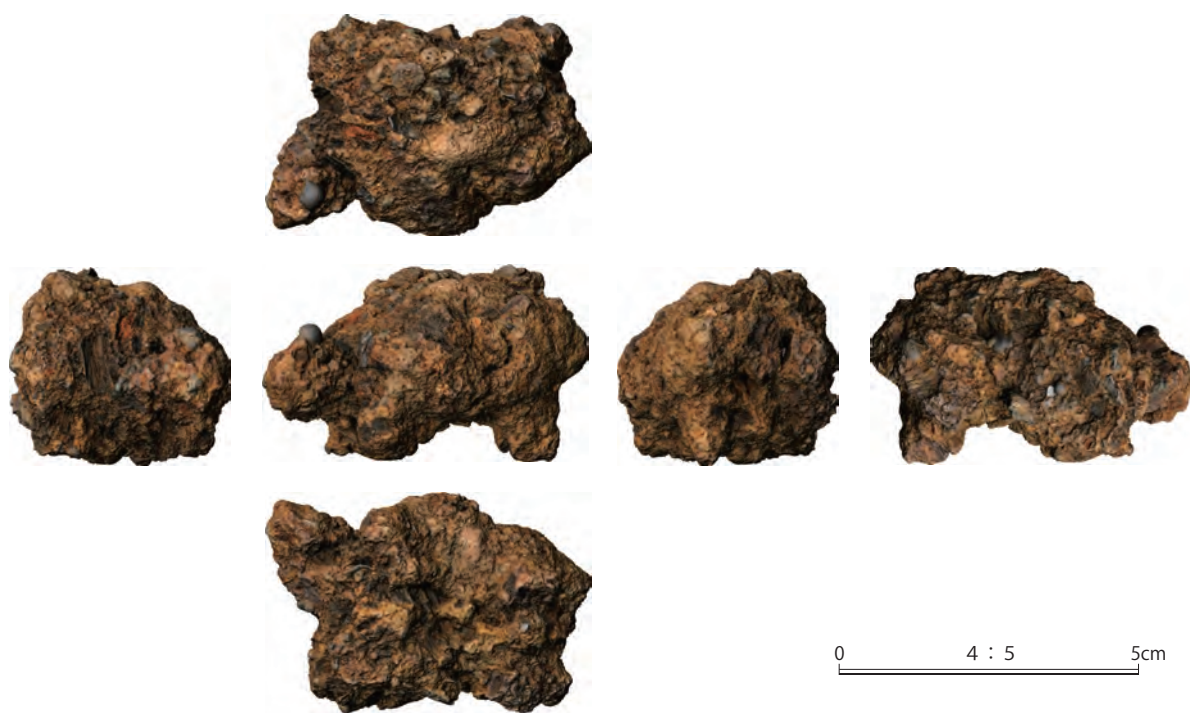
37. 1号竖穴（1号遺構） SL0005 KMG-23 再結合滓（鍛造剥片付着）
