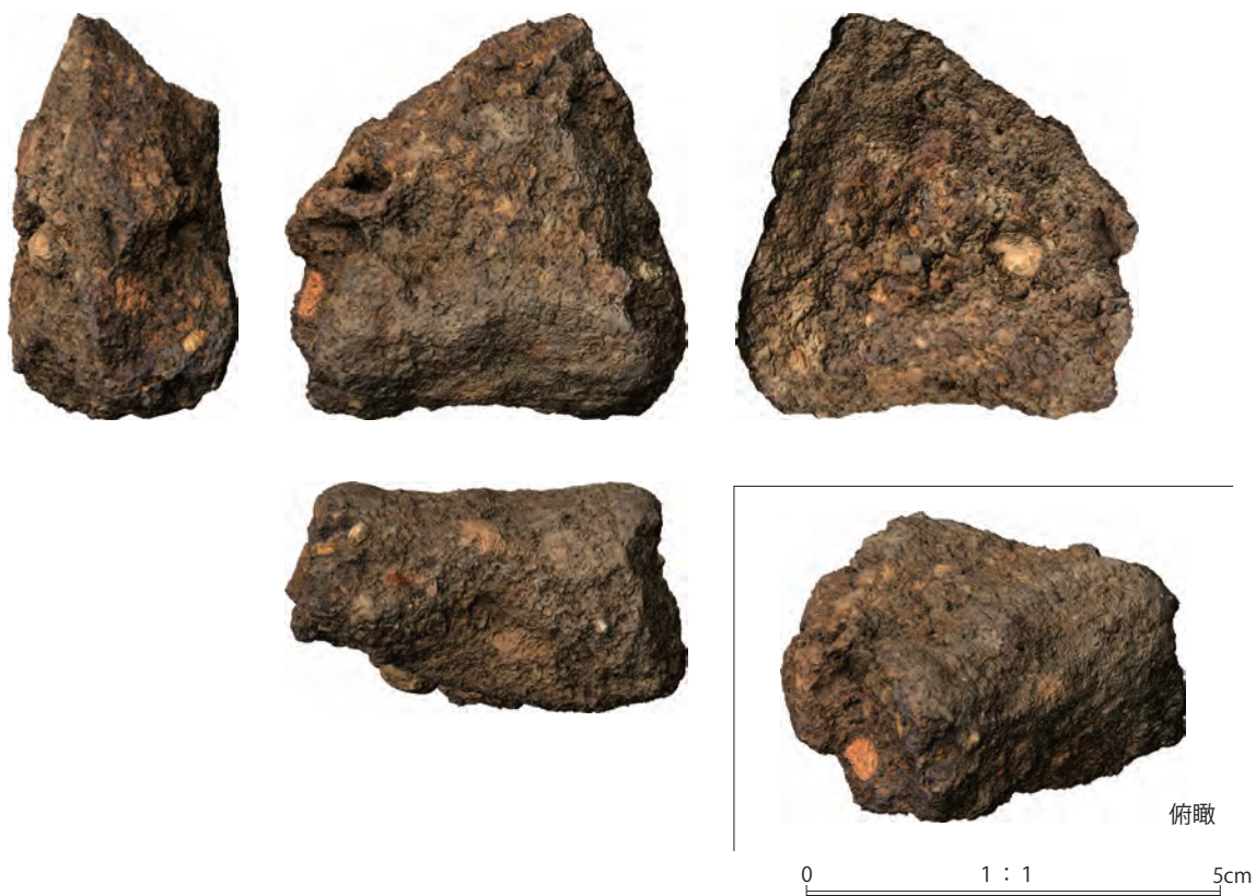
104. 3号炉（6号遺構） SL0009 KMG-45 砂鉄焼結塊
