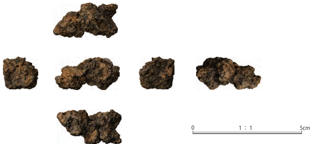
61. 1号炉（2号遺構） SL0010-4 KMG-38-4 含鉄鉄滓
