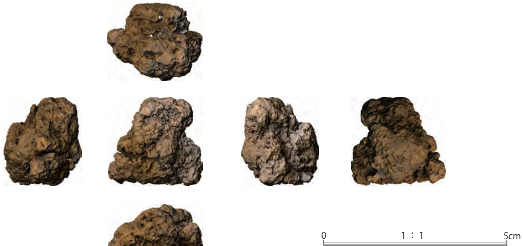
77. 2号炉（3号遺構） SL0001-5 含鉄鉄滓
