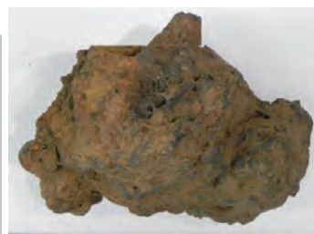
KMG-50 製鍊滓 (炉外流出滓) ④～⑥滓部:ウルホスピ ネル・ファヤライト、微小明 白色粒:金属鉄
