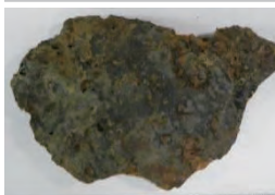
KMG-9 炉壁 ①②内面表層ガラス質 滓、マグネタイト
