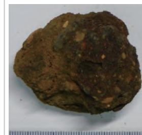
KMG-10 砂鉄焼結塊 ③マクロ組織 ④⑤青灰色粒:被熱 砂鉄(含チタン鉄鉱)、 微小白色部:金属 鉄 ⑥⑦錆化鉄粒、⑥過 共析組織痕跡、⑦亜 共晶組成白鑄鉄組織
