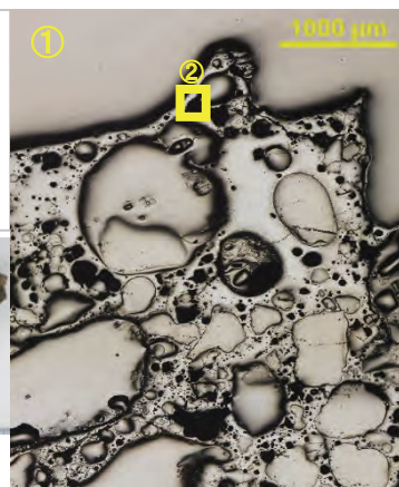
KMG-9 炉壁 ①②内面表層ガラス質 滓、マグネタイト
