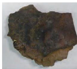
KMG-93 羽口 (大口径) ①外面表層:ガラス質滓、②マ グネタイト、③明灰色粒:砂鉄
