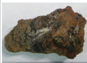
KMG-94 炉壁 (製鉄炉、含鉄) ④～⑥内面表層、砂鉄粒 子還元・滓化、不定形青 灰色部:錆化鉄、滓部:ウル ボスピネル・シュートブルカイト
