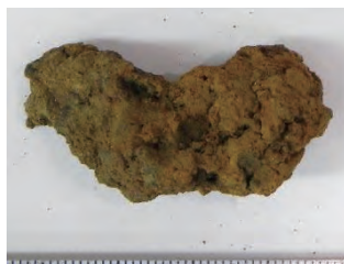
KMG-32 鉄塊系遺物 ①マクロ組織、②滓部： イルメナイト・シュートブルッカ イト、③錆化鉄部：ねず み鑄鉄組織痕跡
