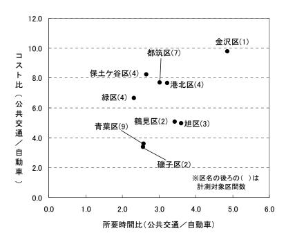
注)所要時間:公共交通は鉄道・バスのダイヤより算出し待時間等は含まない。自動車は Web サイトの Mapfan に より走行距離を算出し、昼間時平均旅行速度を 24.6km/h と設定して所要時間に換算した。
