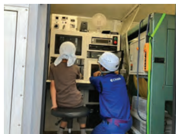
機械（下水道管の中を見るTVカメラ）の操作方法を説明をしている様子
