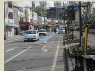
←路上駐輪場と車道の上に自転車専用通行帯を設置するケース。※駐車車両の出入り時に自転車専用通行帯を横断
