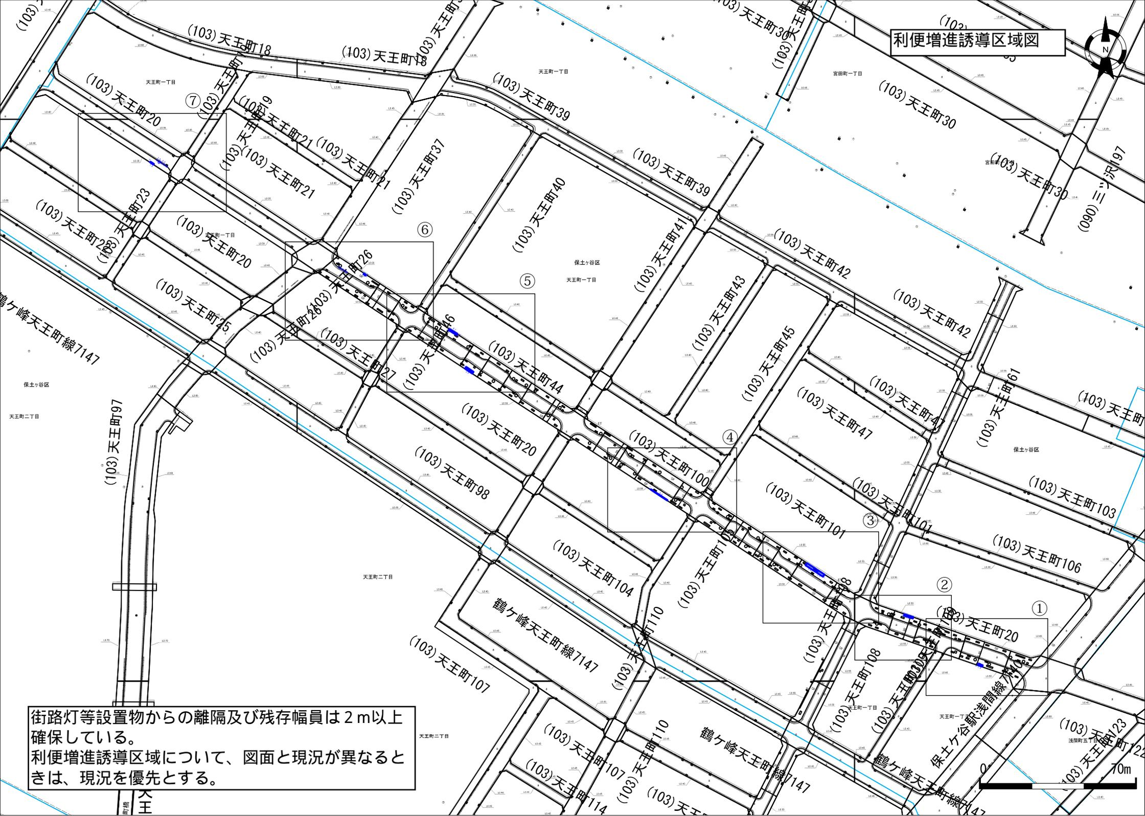
街路灯等設置物からの離隔及び残存幅員は2m以上確保している。
