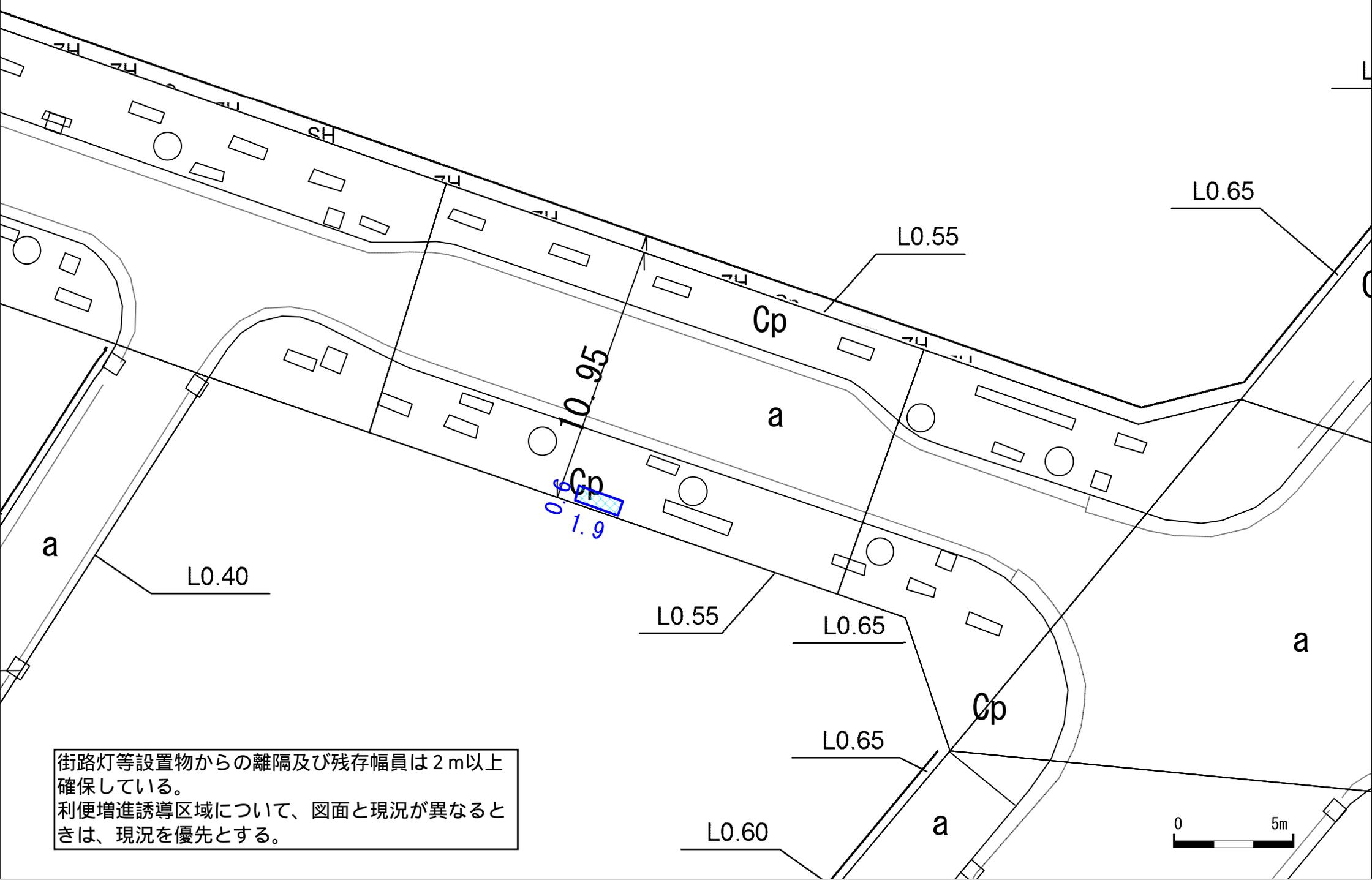
街路灯等設置物からの離隔及び残存幅員は2m以上確保している。
