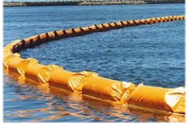
オイルフェンスの使用
