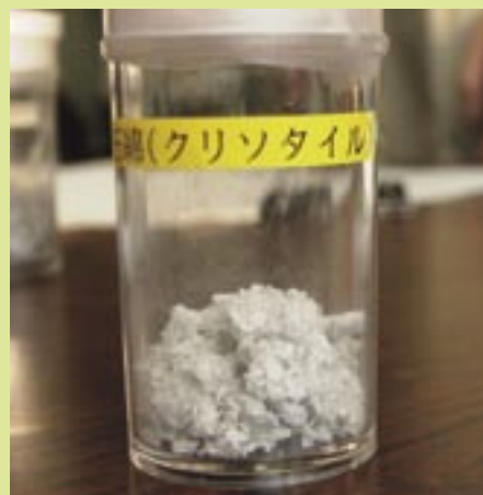
■アスベスト(石綿)の一種、クリソタイルの写真
