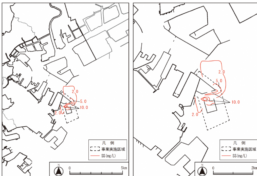
工事中の最大SS濃度分布図 (全層を対象として最大を抽出（最大包絡値）：全体、拡大）
