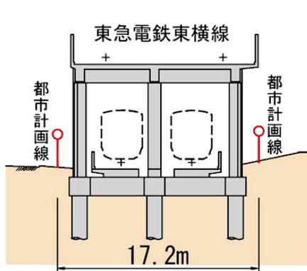
図 1.5-1(7) 高架橋 2 層概略断面図⑦
