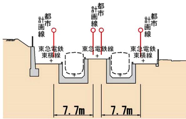
図 1.5-1(8) 擁壁（掘削）概略断面図⑧
