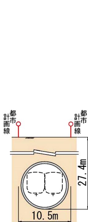
図 1.5-1(4) 円形トンネル（複線）概略断面図④
