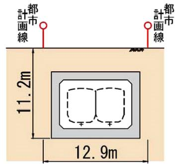
図 1.5-1(1) 羽沢横浜国大駅部概略断面図①
