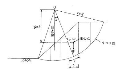
図 6.9-6 円弧すべり面を用いた地震時安定計算法
