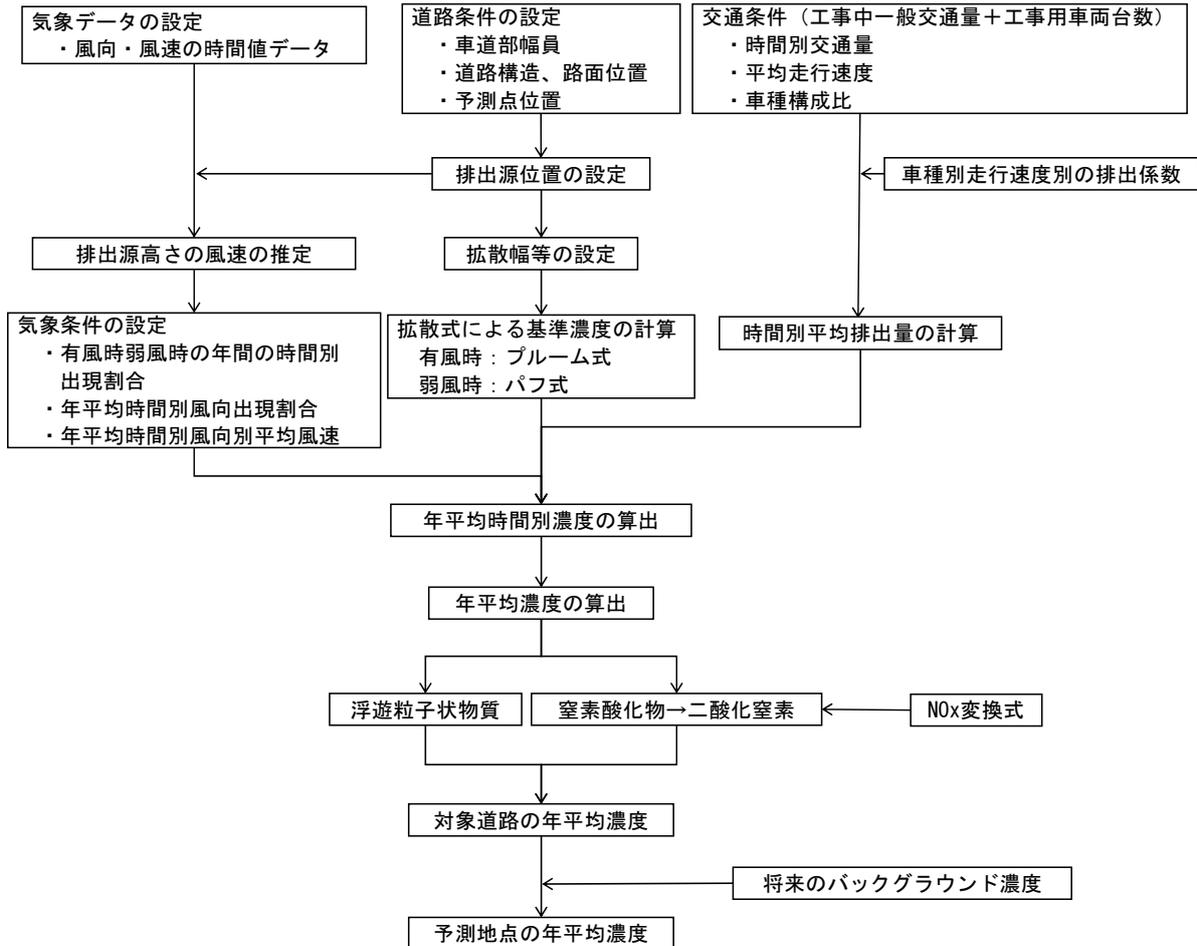
図 6.3-12 予測手順(工事用車両の走行に伴う大気質への影響)
