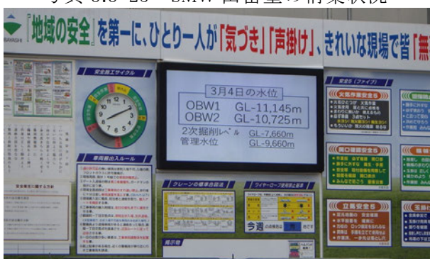
写真 3.3-27 地下水位の計測状況
