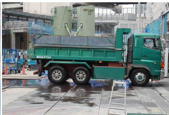
写真 3.1-4 飛散防止装置を装着したトラック
