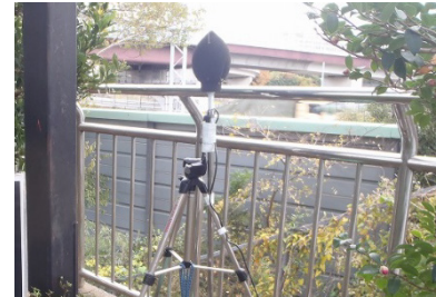
高速道路沿道における騒音測定
