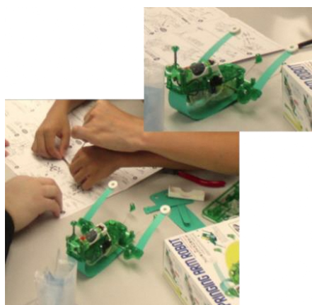
【高学年】プログラミングロボ 直進、右回転、左回転のスイッチを何回押すかで進む方向を入力してプログラミング
