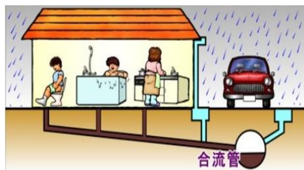
図 2-30 合流式下水道 (雨の日に污水の混じった雨水が流れてしまう)
