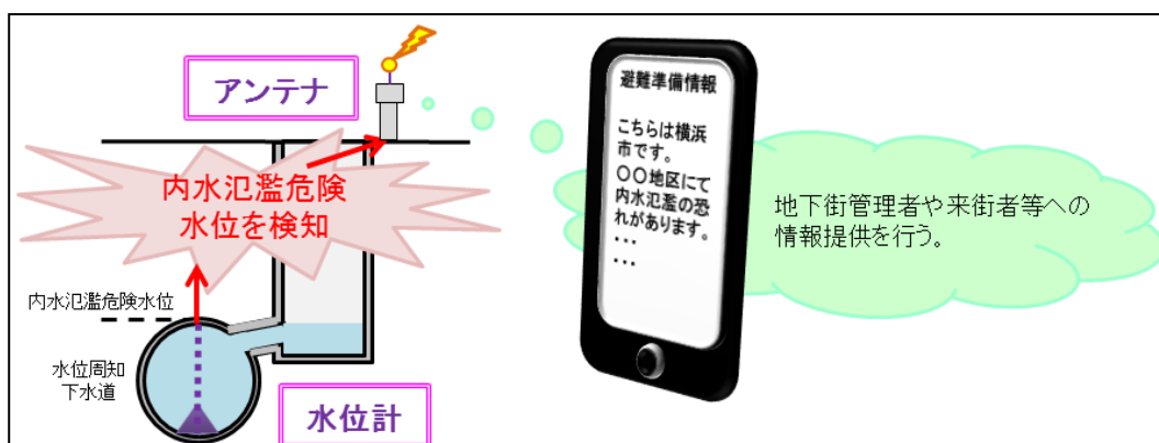
図 2-23 水位周知下水道の概要図
