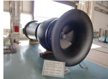
ポンプ再整備後
