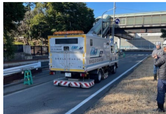
再掲 写真4 空洞探査車による調査
