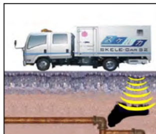
再掲 図1 路面下空洞調査のイメージ
