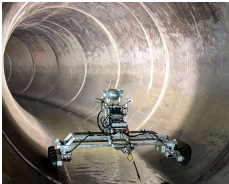
再掲 写真2 中大口径管専用の テレビカメラ
