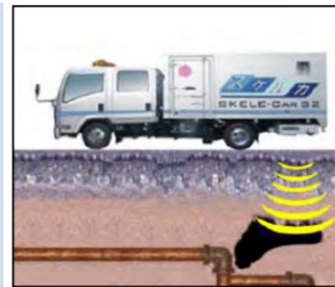
図1 路面下空洞調査のイメージ
