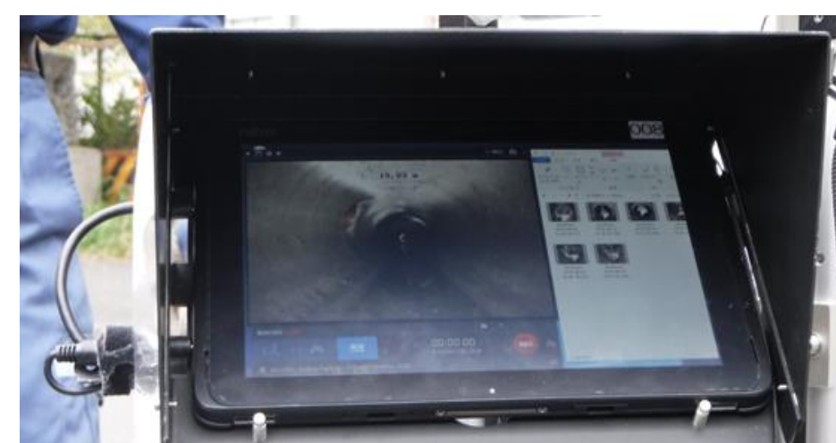
地上部でのモニターにより異常箇所を正確に把握
