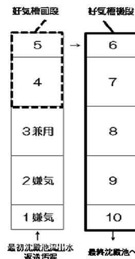
図1 1系反応タンク施設図
