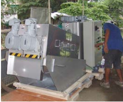
導入された汚泥脱水機
